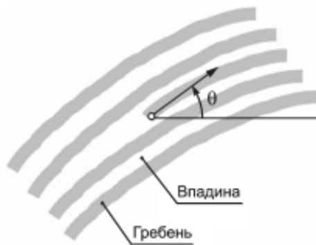
Рисунок 4 — Расположение контрольной точки окончания основы гребней
