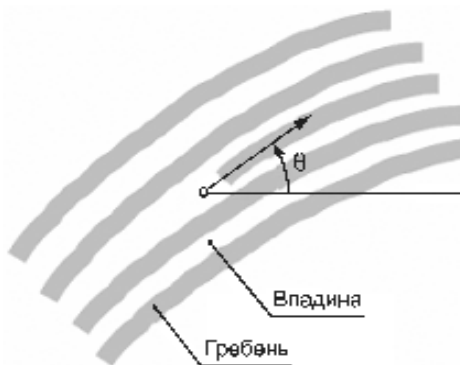
Рисунок 2 — Расположение и ориентация контрольной точки окончания гребня, определенной через точку бифуркации основы впадин
