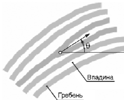
Рисунок 3 — Расположение и ориентация контрольной точки бифуркации гребня, определенной через точку бифуркации основы гребней
